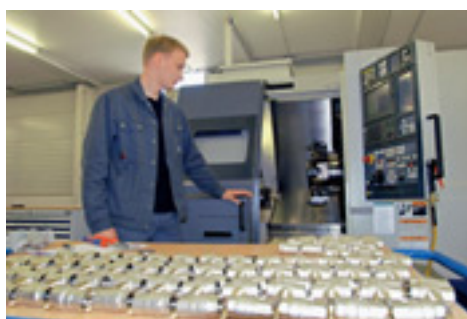
Mit Fräsmaschinen werden im eigenen Hause die Prototypen erstellt oder auch Kleinserien auf spezielle Kundenwünsche angepasst. Andreas Kiewe lässt hier zum Beispiel Gewinde auf Kugelhähne fräsen, damit diese in Schaltschränke eingebaut werden können.
