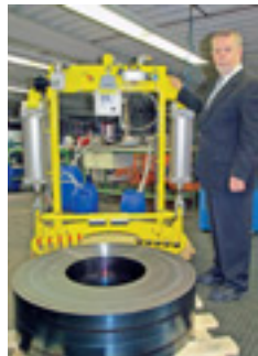
Schwere Coils können mit den Vakuumhebeanlagen, die hier firmenweit Herbert Timmer präsentiert, mühelos angehoben werden.
